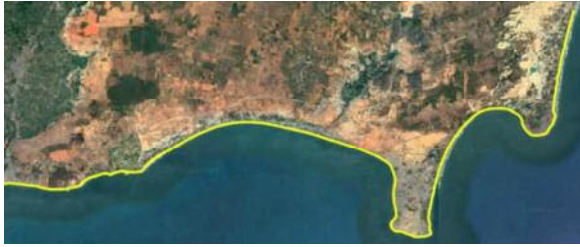
Hình 6. Kết quả đường bờ biển được trích xuất từ ảnh Google Earth bằng phương pháp số hóa
