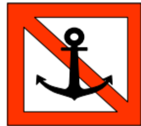
Báo hiệu cấm thả neo, cấm kéo rê neo, cáp hoặc xích (C1.2)
