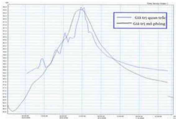
Hình 5. So sánh giá trị mô phỏng và quan trắc đường mực nước tại trạm Thượng Nhật sau hiệu chỉnh mô hình
