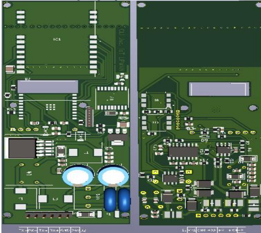
Hình 7. Mô phỏng 3D mạch in trước khi hàn linh kiện điện tử (mặt trước và mặt sau).
